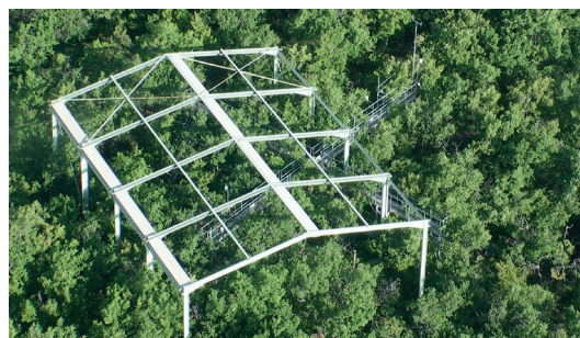
Photos 2 et 3. Parcelle de 300 m 2 située à l'O3HP (AnaEE - France et Europe) permettant de simuler les précipitations futures à l'aide d'un toit qui se ferme pendant ~20 jours par an (© Elena Ormeno Lafuente).
