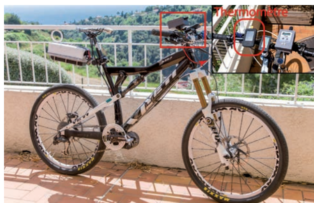
Photo 4. Vélo et capteurs disposés pour les mesures itinérantes
